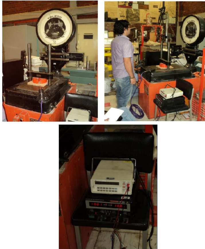
Figura 38. Calibración de celdas de presión
