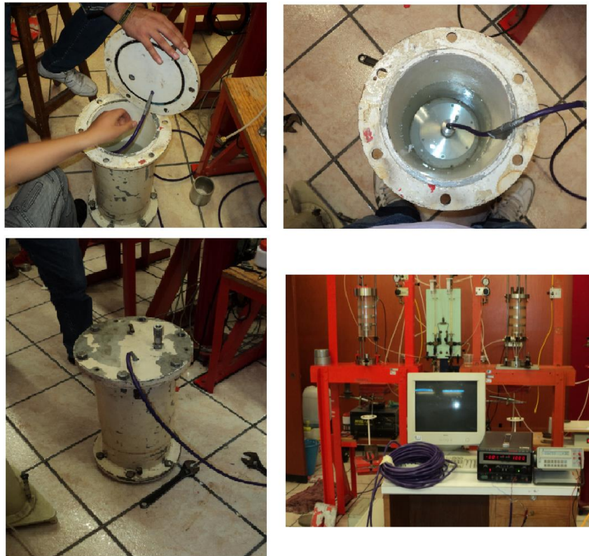
Figura 39. Calibración celdas de presión tipo Jack-Out
