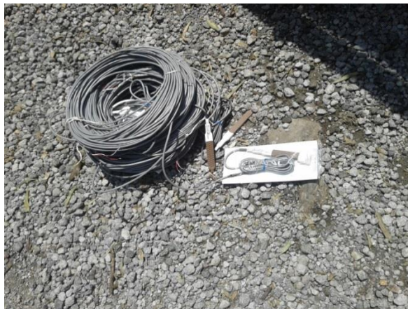
Figura 31. Deformímetro de un cuarto de puente
