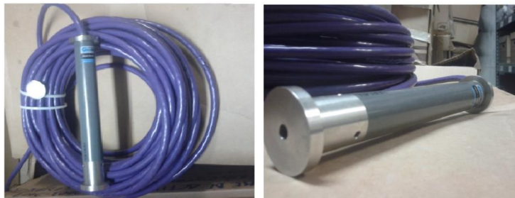
Figura 32. Deformímetros de puente completo
