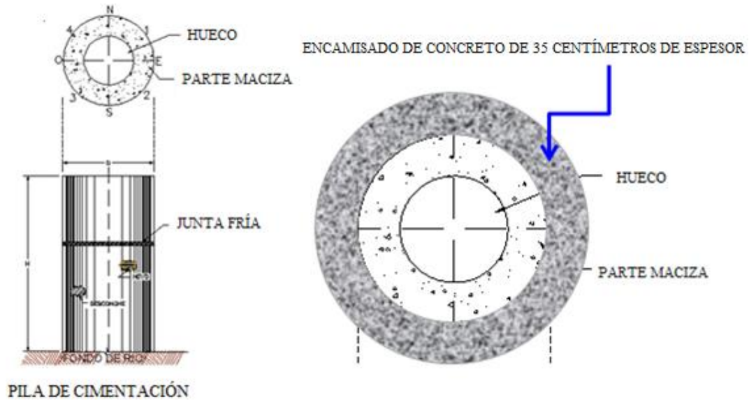
Figura 1.16. Intervención en las pilas de cimentación en los ejes 12 y 13 [1.3].
