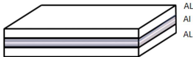
Figura I.5. Compuesto laminado metálico simétrico con capas isotrópicas
