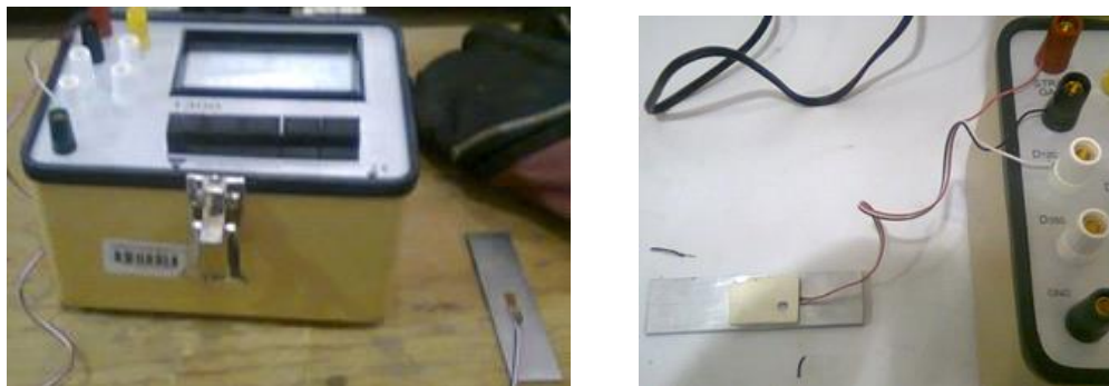
Figura 5.5. Extensómetro conectado al Tester Model 1300 Vishay
