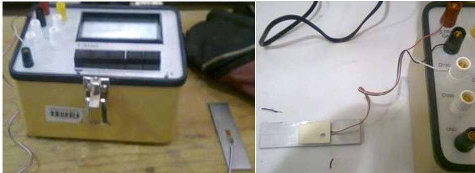
Figura C.31. Galga instalada en probeta conectada al Tester Model 1300
