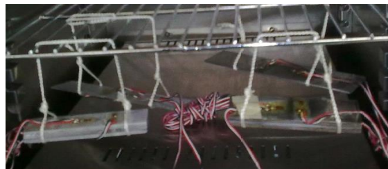
Figura D.4. Probetas dentro de la cámara y conectadas al P3-Strain
