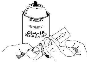
Figura C.9. Proceso de limpieza zona de la galga
