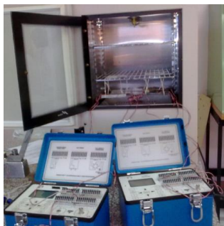
Figura D.4. Probetas dentro de la cámara y conectadas al P3-Strain
