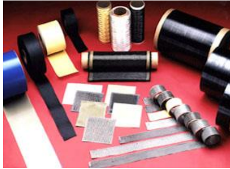
Figura A.2. Cintillas unidireccionales usadas en la fabricación de compuestos [1]
