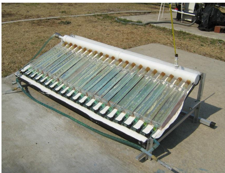
Figura 27. Reactor fotocatalítico solar energéticamente autosuficiente basado en colectores CPC.
