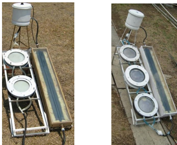
Figura 40. Reactor fotocatalítico con colectores hemisféricos en serie (Planta Solar, Ciudad Universitaria, UNAM, Ciudad de México).
