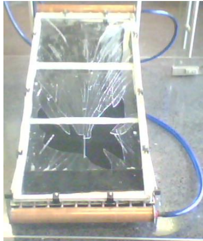
Figura 32. Reactor fotocatalítico basado en un colector plano, roto tras prueba con agua.
