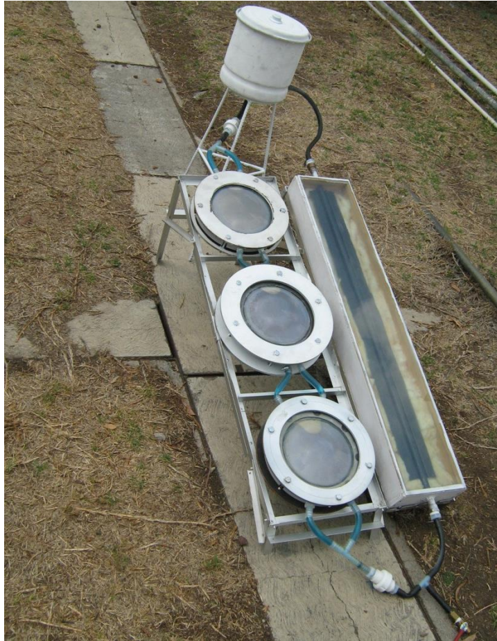
Figura 26. Reactor fotocatalítico solar energéticamente autónomo basado en colectores hemisféricos.
