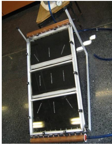
Figura 33. Reactor fotocatalítico. Colocado en su base a 19° de inclinación con travesaños en los marcos inferior y superior, escuadras para sujetar los marcos y mamparas para desviar el flujo
