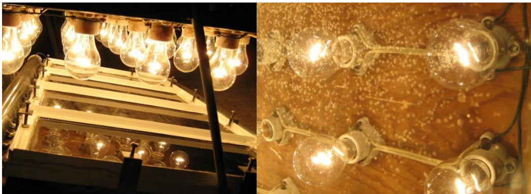
Figura 35. Prueba del colector RF 01 con banco de focos y con tanque a nivel del piso
