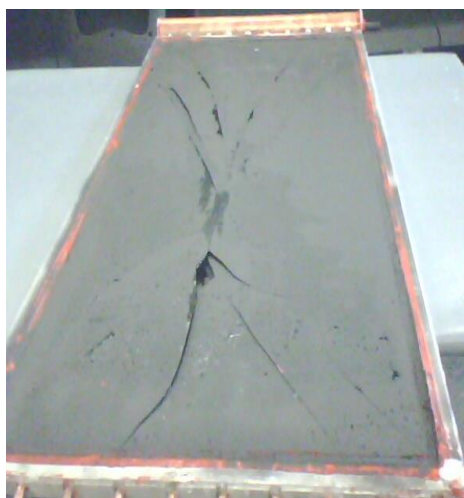
Figura 31. Parte inferior del primer prototipo de reactor fotocatalítico tras ruptura en pruebas hidrostáticas.
