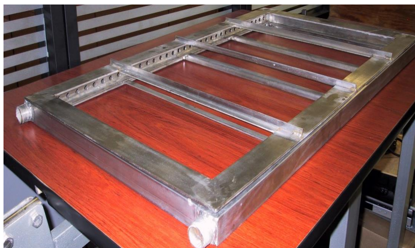
Figura 37. Estructuras base del colector plano RF03 con conectores y configuración interna.
