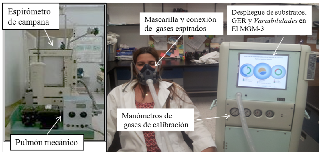
Figura 3.13. Banco de pruebas con pulmón mecánico y con espirómetro de campana. También, se muestra al MGM-3 haciendo un estudio de CI con un sujeto de prueba. El despliegue de información es forma de una interface intuitiva de fácil comprensión para nutriólogas, enfermeras y médicos. Las formas de pastel sintetizan las mediciones del GER, substratos metabólicos y la variabilidad del intercambio gaseoso, junto con la VFC.
