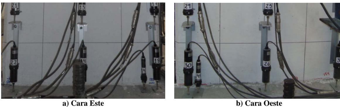
Figura 5.1. Primeras grietas de flexión de espécimen PH2
