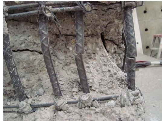
**d) Fractura de barras longitudinales (Suroeste)**
