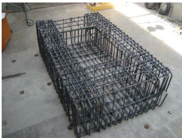
Figura 4.1. Armado del acero de refuerzo de la zapata de los especímenes
