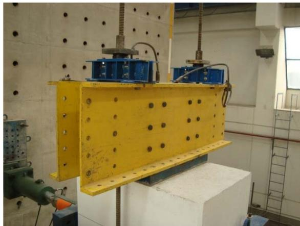
**Figura 4.15. Detalle del dispositivo de aplicación de carga axial**
