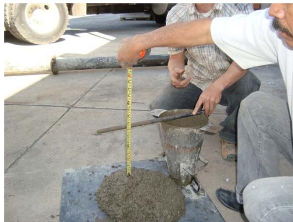
**Figura 4.9. Prueba de revenimiento**
