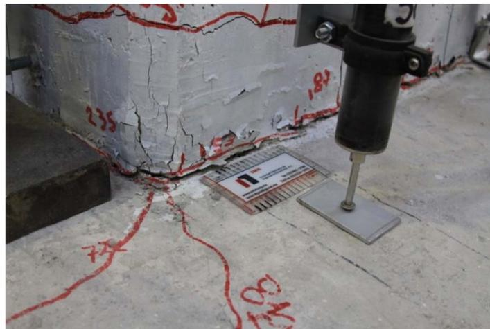
**Figura 6.7. Deformación de la junta fría de concreto pila – zapata**
