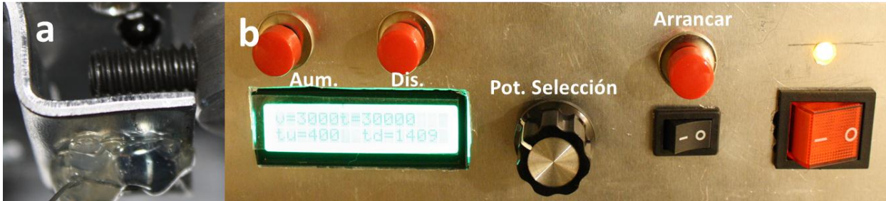
Figura 65 a) Tacómetro b) Tablero de control de funciones del Spin Coater
