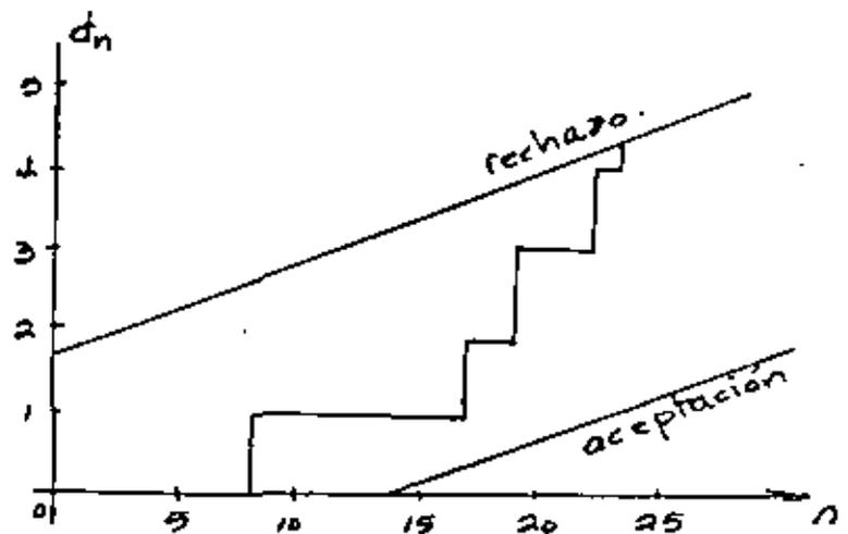
En el ejemplo a los 23 elementos inspeccionados se obtuvo  $d_n = r_n$ , por lo tanto termina el muestreo con rechazo del lote.
