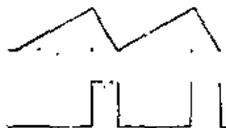
Figura 21. Conversión de rampa a impulsos.
