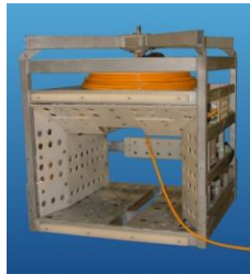
Fig. 5.1 TMS (Tether Management System). Fuente [23]
