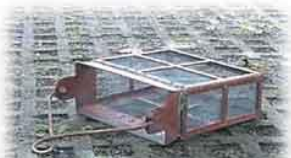
Fig. 3.2 Recolectación por medio de dragas de arrastre en fondos blandos (zona: más de 30 metros).
