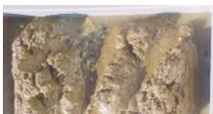
Fig.3.4 Muestra "perturbada" obtenida con un recogedor tipo "cuchara"
