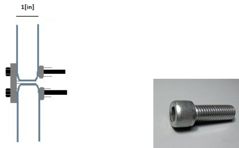
Fig. 5.25 Vista lateral y ejemplo de tornillos de acero inox.304 Allen cabeza cilíndrica y colocación de los tornillos. Fuente [9]
