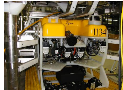
Fig. 5.4 ROV dentro de su TMS y base con brazo robótico (fuera del alcance de este trabajo).Fuente[23]
