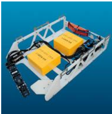
Patín de Manipulador de 5 Arrojador de agua presión Funciones
