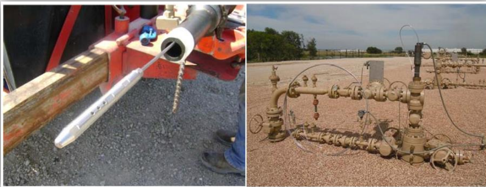
Figura 4.8 Imágenes de un tubo capilar y su instalación en pozo (Farina, 2012).
