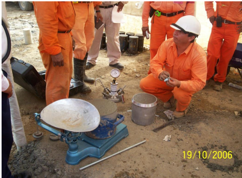
Fotografía. 6.15.- Determinación del Contenido de Aire en Concreto Fresco.
