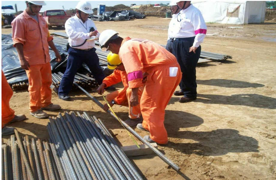
Fotografía. 6.5.- Obtención de muestras de acero para ensayos de resistencia.
