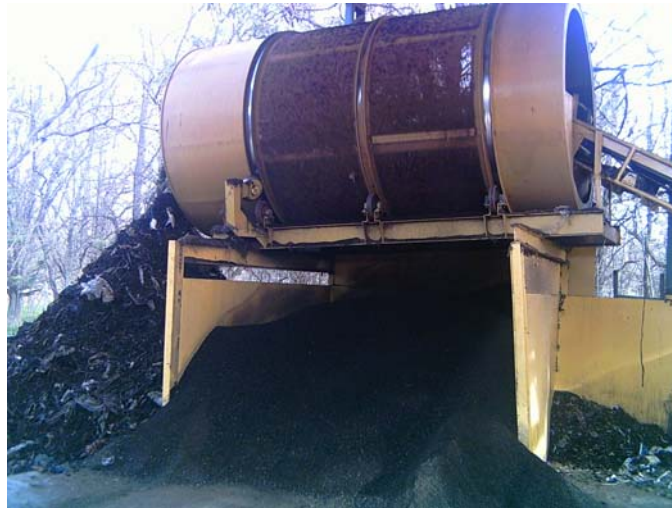
Figura 2.14 Trommel utilizado en planta de composta en Buenos Aires
