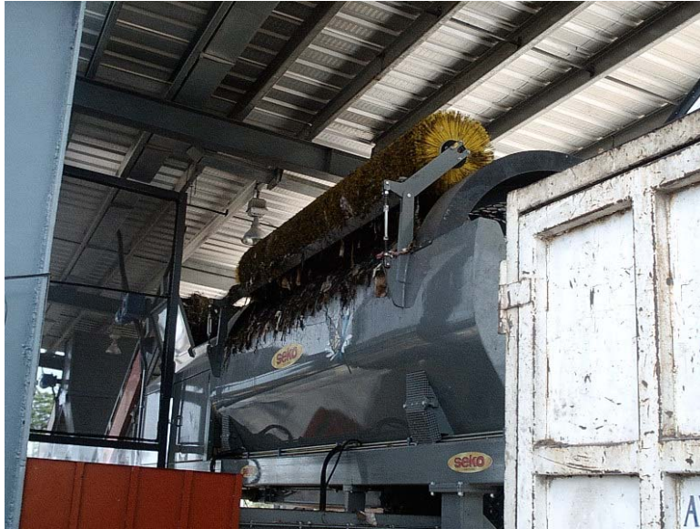
Figura 2.12. Rodillo limpiador del trommel
