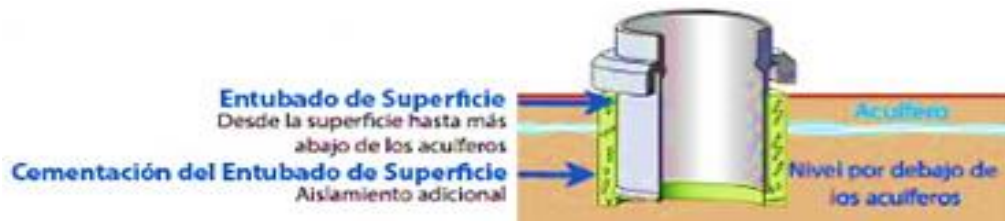
Figura 3.31: Entubado de superficie y cementación de alta resistencia para proteger los acuíferos (BNK, 2012)
