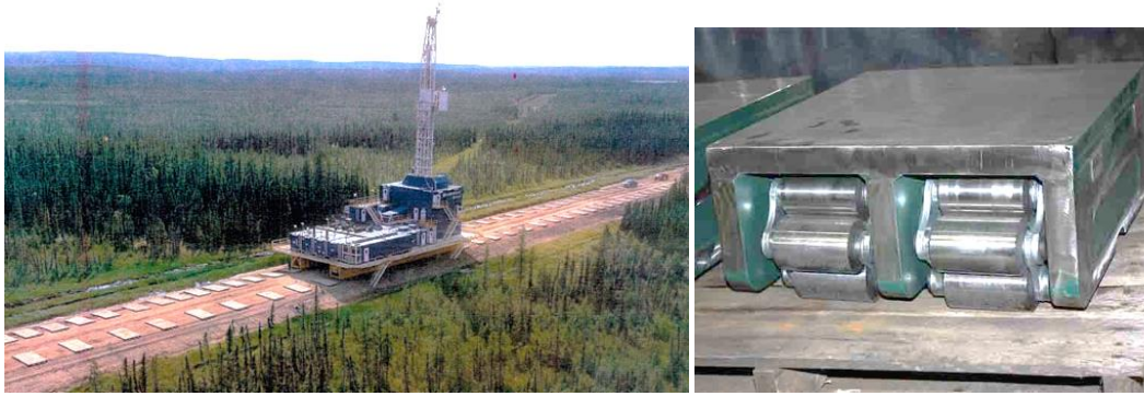
Figura 3.9: Movilización de un equipo de perforación mediante un sistema deslizante (ENTRO, 2014).
