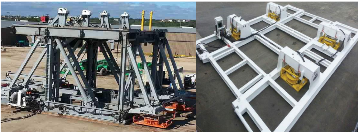
Figura 3.11: Equipo móvil con piernas laterales (izquierda) y base con pies para la sub estructura (derecha) (ENTRO, 2014).
