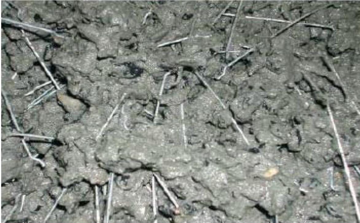
**Fig. No. 137 Concreto reforzado con fibras de metálicas**
