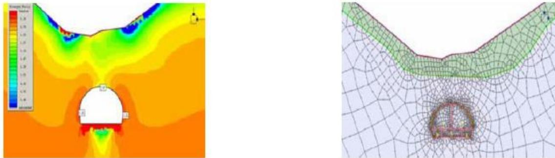
Fig. No. 29 Método de elementos finitos
