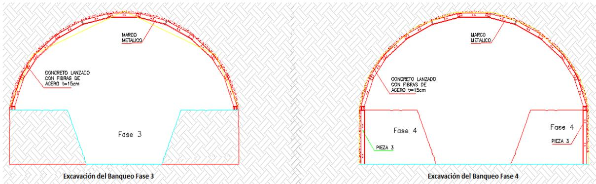
Fig. No. 87 Excavación del banqueo fase 3 y 4 en Condición Geotécnica "D(+)"
