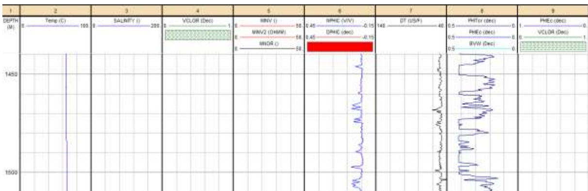
Figura 48. Interpretación petrofísica en intervalo de 1,440 m a 1,510 m en el Pozo 3 (software IP, Senergy).
