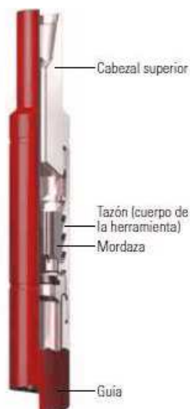
Figura 8.4.2.1a Pescante de cuñas (Modificado de: Como optimizar el Arte de la Pesca , Schlumberger, 2012).
