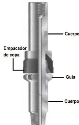
Figura 8.4.1.3b Arpón con empacador de copa (Schlumberger, 2012).
