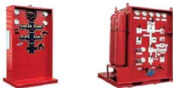
Figura 1.1.1.8h Bomba Koomey. (Petróleos Mexicanos PEP-UPMP, Programa de Acreditación en Control de Pozos, Wellcap).
