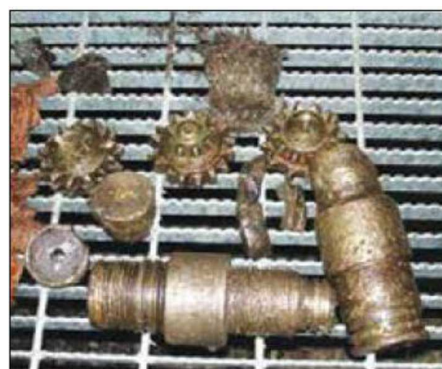
Figura 7.4b Ejemplos de piezas metálicas considerados como chatarra para pesca (Jhonson Enes, Schlumberger, 2012).
