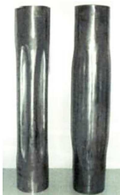
Figura 10.3.1 Proceso de expansión con agua, antes y después.
