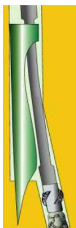
Figura 5.2.5.3 Desviador de pared permanente (Schlumberger, Nuevos Rumbos en la Perforación Rotaria Direccional , 2000).
