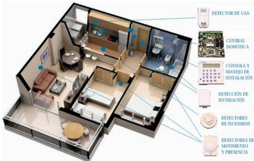
Fig. 1.1 Ejemplo de distribución de componentes de seguridad. [2]
