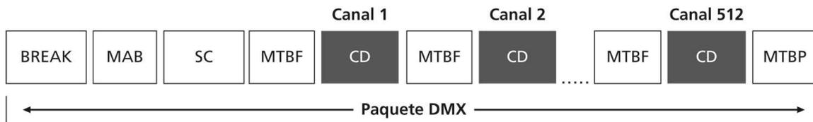
Fig. 1.12 Estructura del protocolo DMX512. [13]
