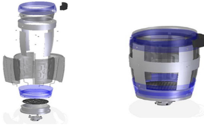
Figura 2.11. Sujeción del socket autoajustable [10].
