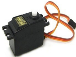
Figura 3.7. Servomotor analógico empleado en servoválvula.
