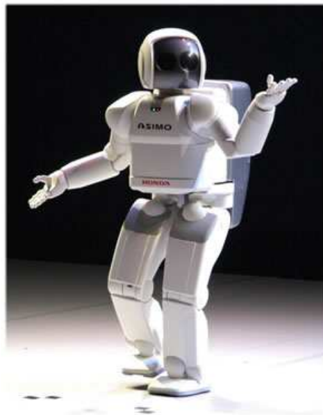
Figura 2.6: ASIMO (Advanced Step in Innovative Mobility), el robot humanoide más avanzado de Honda y uno de los robots bípedos más versátiles en el mercado
