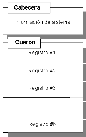
Figura 1.7. Estructura de un archivo en la norma ISO 7816-4.
