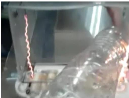
*Figura 47.-Muestra el des alineamiento de la botella al pasar por el área de corte y choca con los filamentos de Nichrom.*
