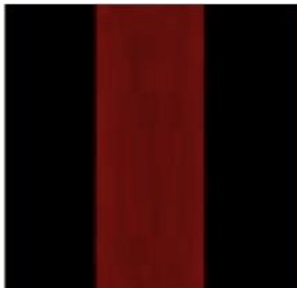
Figura 6.14 Imagen en tonos de rojo obtenida al realizar mediciones tridimensionales a una pieza cilíndrica. Los parámetros de Distancia mínima y Distancia máxima son 70 y 200 respectivamente.
