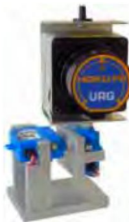
Figura 2.14 Sistema de medición tridimensional basado en un telémetro URG-04LX de la marca Hokuyo.
