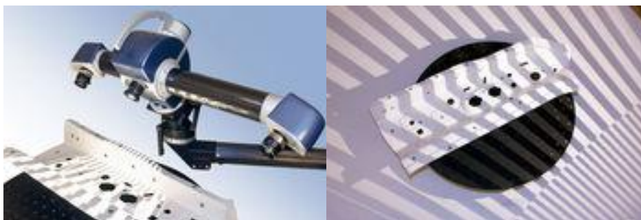
Figura 2.2 Patrones de franjas de luz halógena distorsionados al ser proyectados sobre el objeto que se desea digitalizar.
