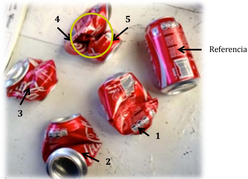
Figura 6.15 Latas obtenidas al compactar cinco latas
