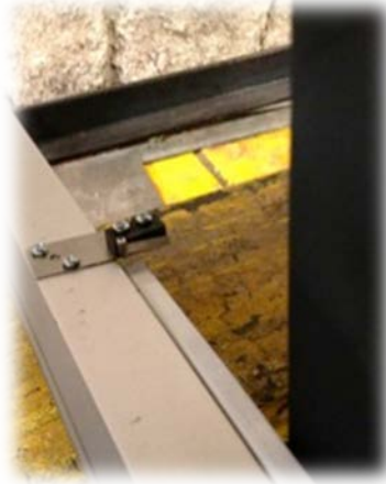
Figura 5.14 Microswitch del cajón para acumular las latas compactadas
