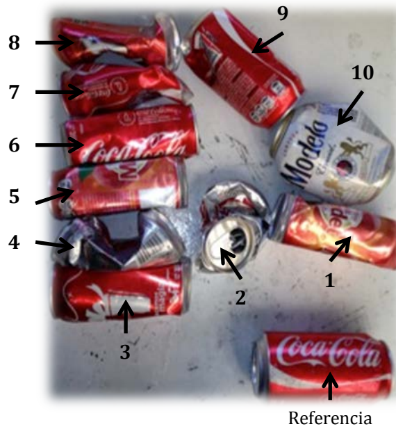
Figura 6.16 Latas obtenidas al compactar diez latas
