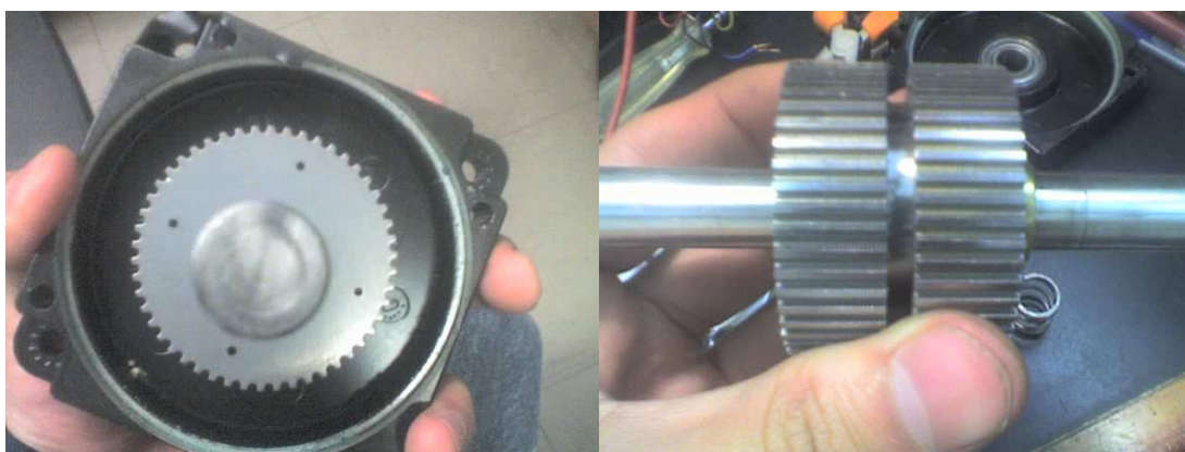
(b) Rotor del motor de cinco fases.
