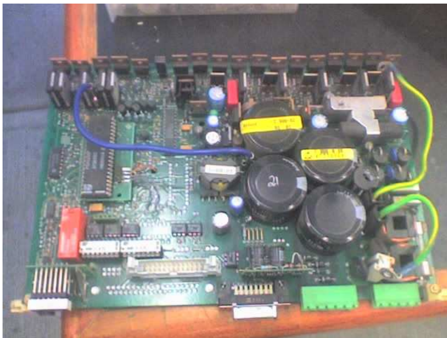
Figura 50 Etapa de potencia del controlador (WDP 5-228) montado en la máquina.
