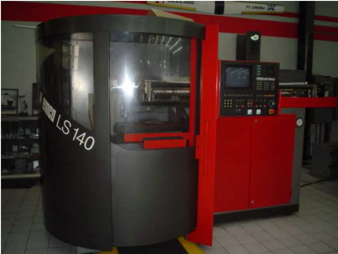
Figura 2.2 Máquina CNC láser EMCO Ls 140.
