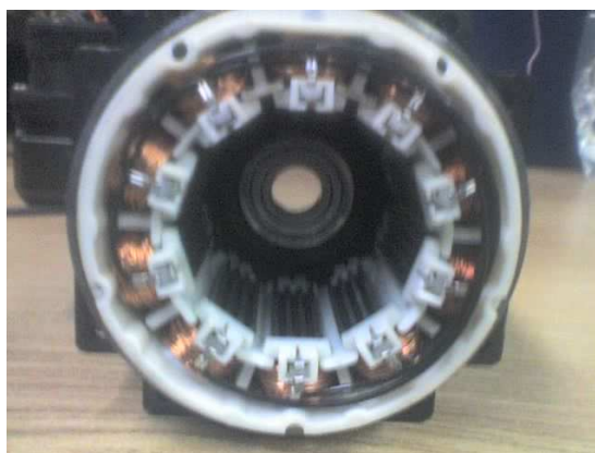
(a) Estator del motor de cinco fases.
