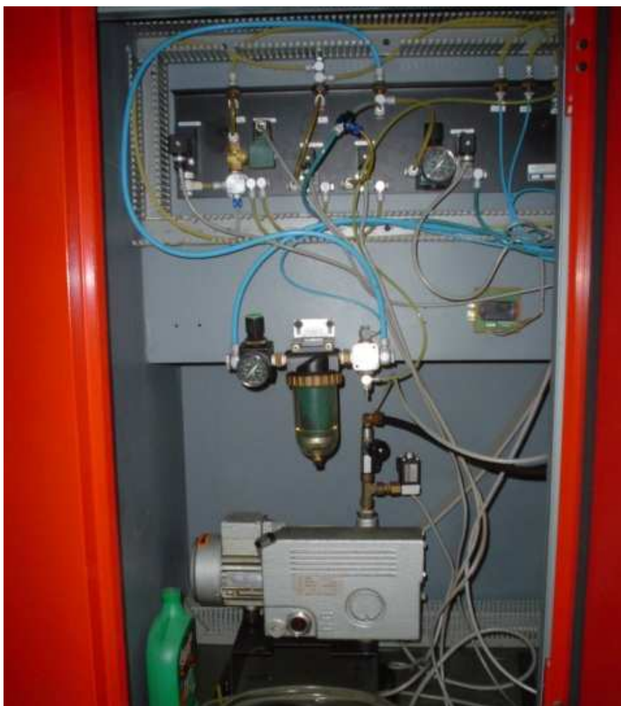
Figura 2.10 Conexiones de las mangueras, bomba de vacío, válvulas y filtro de la máquina CNC.
