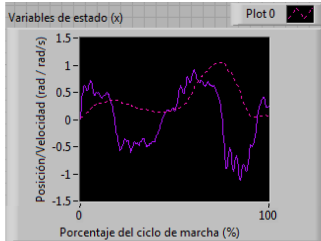
Figura 5.15. Resultados de las pruebas de la articulación Rodilla: Variables de estado ( x )
