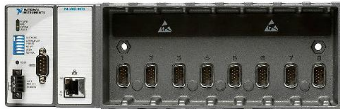
Figura 4.1. NI cRIO-9073 CompactRIO con chasis y controlador integrado
