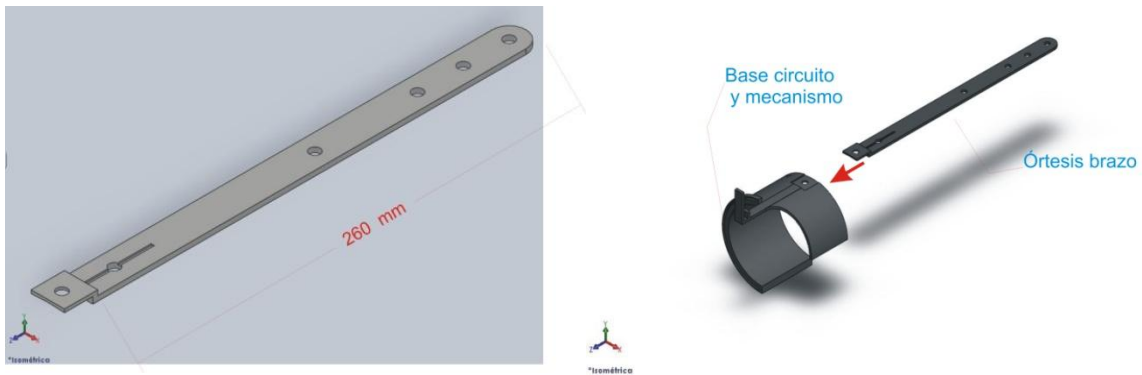
Ilustración 18 órtesis de antebrazo y su explosión con respecto a la base circuitería y mecanismo
