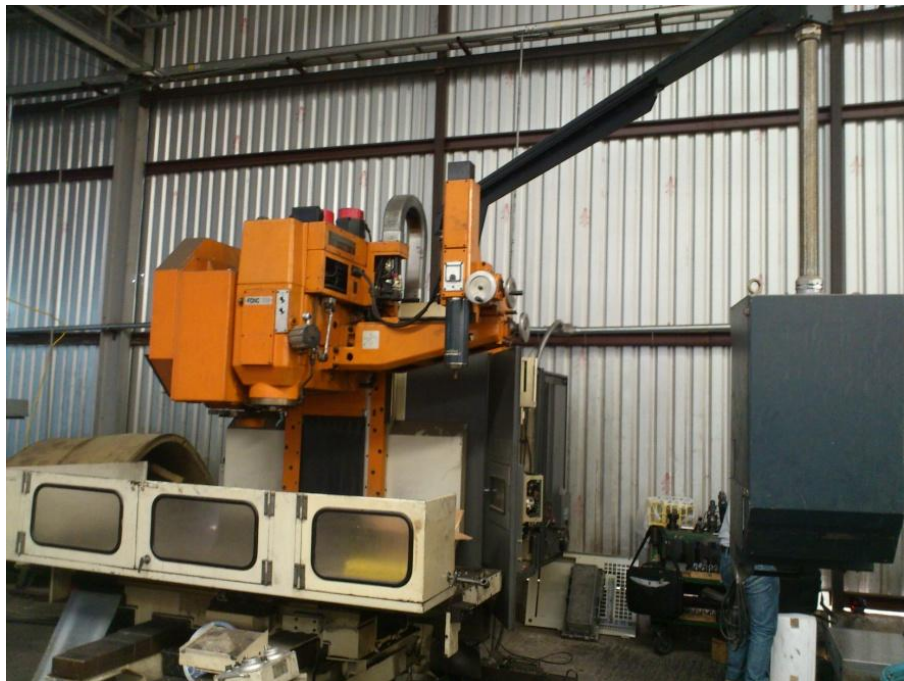
Fig. 3 Centro de maquinado MAKINO
