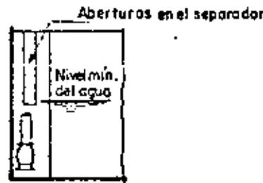
Figura BF-37 (f) - ( 8 ) - Una alternativa para (b) es establecer respiraderos en las paredes laterales, partiendo del centro al punto más bajo del nivel mínimo del agua; esto permitirá desalojar el flujo de las cámaras donde no existe el bombeo.
