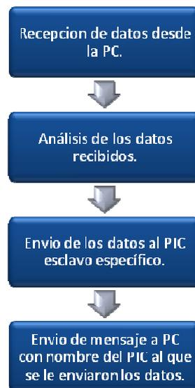
Figura 7.11 Diagrama de funciones del PIC maestro.
