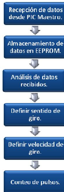
Figura 7.4. Diagrama de pasos de PIC esclavo.
