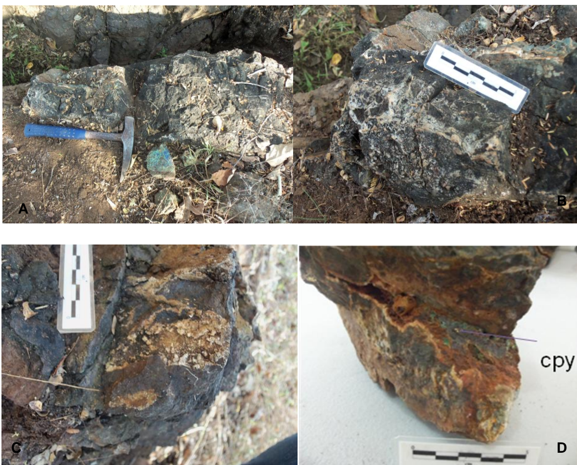
Fotografía 14. (A) Brecha candil (extensión China 1), vista de una obra superficial de la estructura, así como un fragmento con tonos azules que evidencian la mineralización supergénica de cobre, (B) Detalle del cementante cuarzo lechoso que predomina en el afloramiento. (C) Detalle de cavidades rellenas con cuarzo crustiforme. (D) Mineralización característica en superficie de China 1 donde se notan en tonos verdes la mineralización supergénica y algunos macro cristales de calcopirita.
