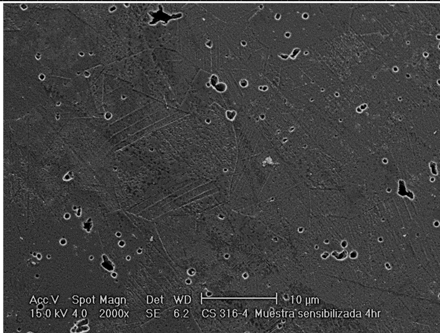
Figura 78. Microestructura de la muestra de AISI 316 sin deformación y tratamiento de sensibilización de cuatro horas a 2000X.
