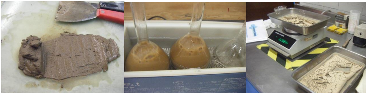
Fig. 39. Homogenizado del material, desairado de matraces y peso del material seco.
