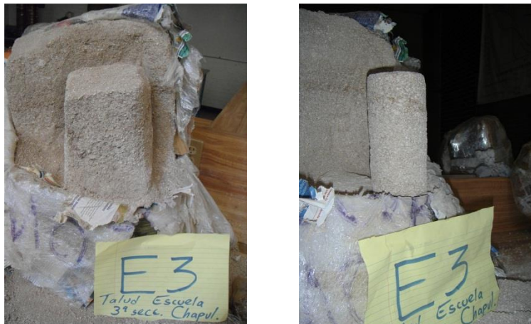
Fig. 36. El procedimiento del tallado de las probetas para la muestra de compresión simple.
