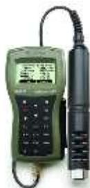
Figura 4.1. Medidor multiparamétrico Hi 9828
