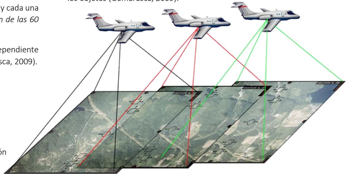
Figura 9. *Fotografías aéreas, obtenidas a partir de un vuelo fotogramétrico*
