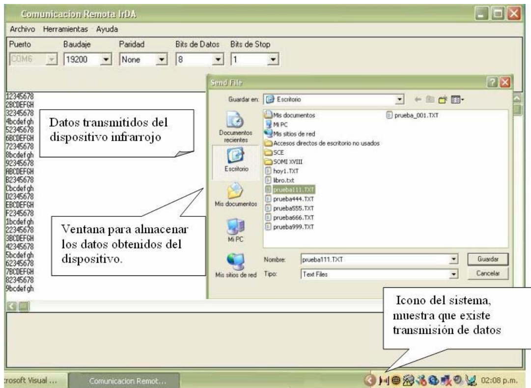
Figura 3.39. Operación de la interfaz IrDA.
