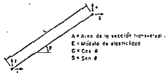
Fig. 2.19 Propiedades y grados de libertad de una diagonal
