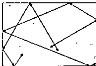
FIG. 2.7. — Reflexión de un sonido sobre las paredes de un local.
