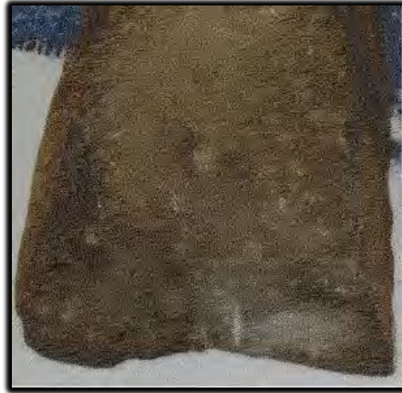
Figura 2.22 Gravaca (Laboratorio de petrología, F.I.).
