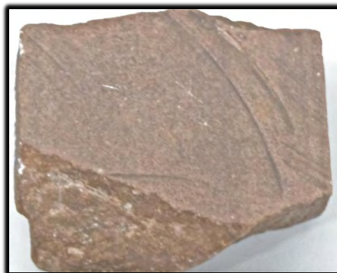
Figura 2.19 Cuarzoarenita (Laboratorio de petrología, F.I.).
