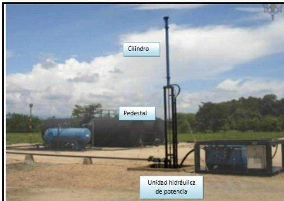
Figura 1.26 Unidad Hidroneumática TIEBEN
