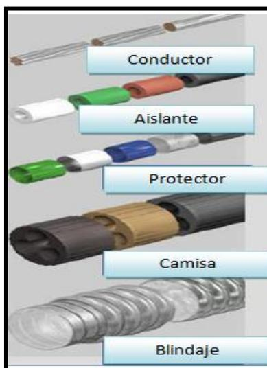
Figura 2.22 Materiales usados en el cable de potencia
