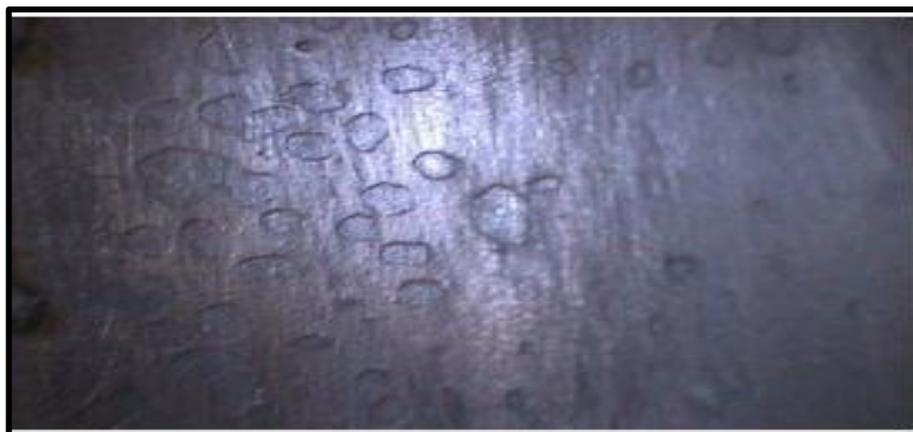
Figura 4.61 Azufre producto de la corrosión del acero al carbono
