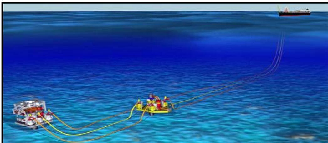
Figura 4.41 Equipo BEC instalado en el fondo marino como un sistema artificial de producción primario
