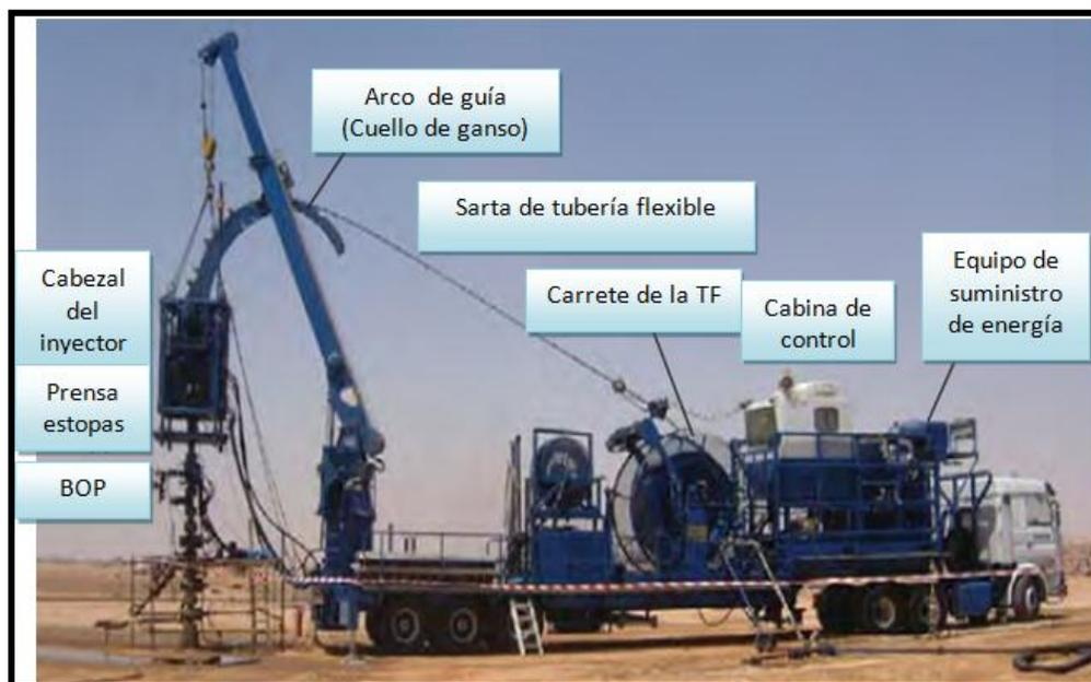
Figura 3.8 Equipo de Tubería Flexible
