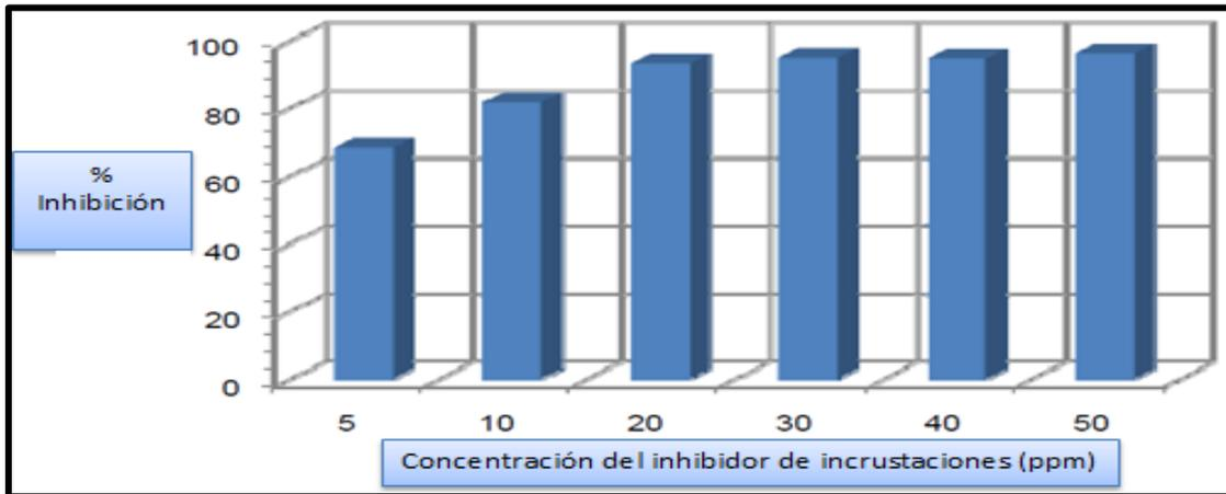
Figura4.54 Inhibición de sulfato de bario a 180[°F], durante 24 horas con una relación de agua sintética con agua de mar de 50:50
