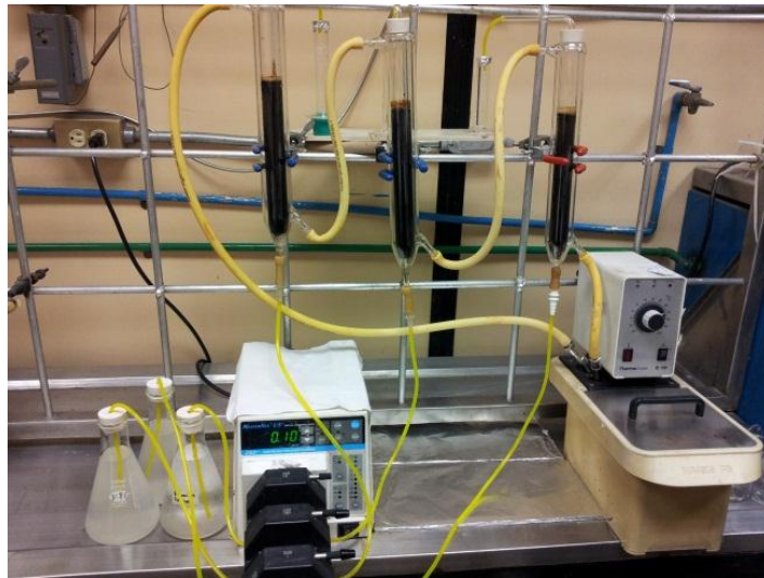
Figura 7. Columnas empacadas e impregnadas con aceite antes de la inyección del bioproducto
