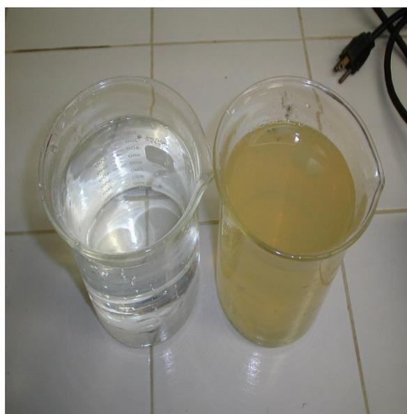
Se observa la muestra de agua captada por la lluvia y el agua después de haber pasado por los filtros potabilizada.
