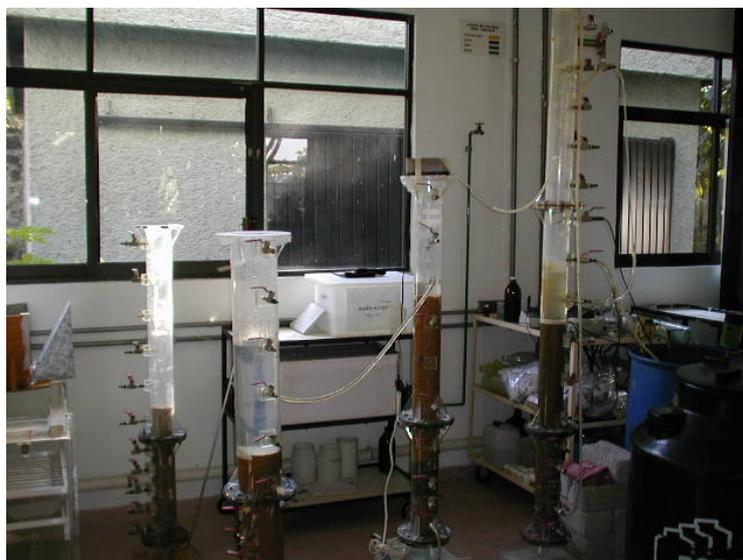
Consiste en depositar el agua de lluvia en el filtro y pasarla por diferentes granulometrías de mas gruesa a mas fina, la trayectoria del flujo es descendente y posteriormente ascendente hasta llegar a las arenas mas finas.
