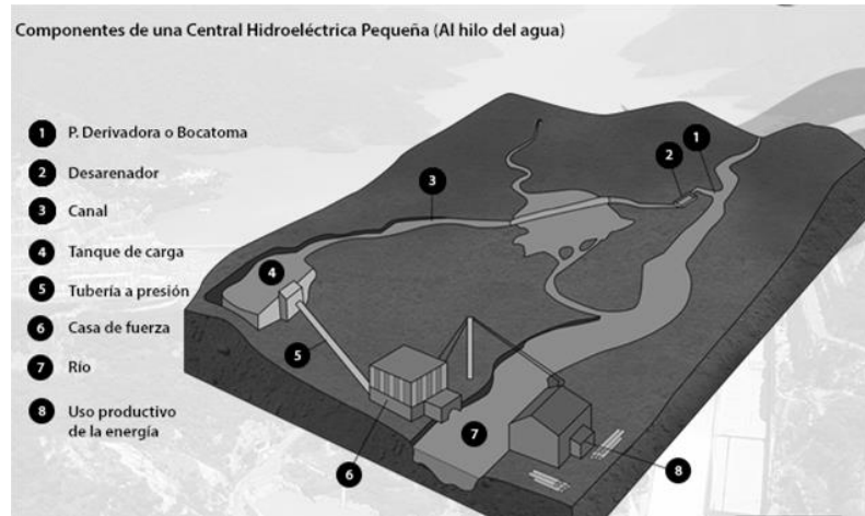
FIGURA 2.11: Pequeña central hidroeléctrica, (5).
