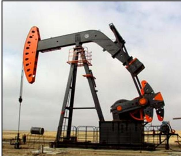
**Figura 1. 11 Unidad de Bombeo Mecánico Convencional**
