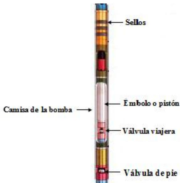
Figura 1. 9 Diagrama de bomba subsuperficial de Bombeo Mecánico
