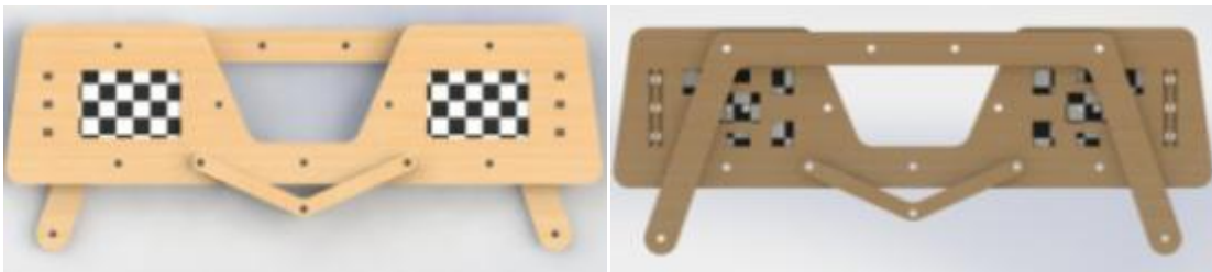
Figura 3.88. Vista superior de la segunda versión del sistema de orientación (izquierda). Vista inferior de la segunda versión del sistema de orientación (derecha).
