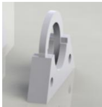
Figura 3.24. Imagen de la base para potenciómetro multi-vuelta en el software de diseño.
