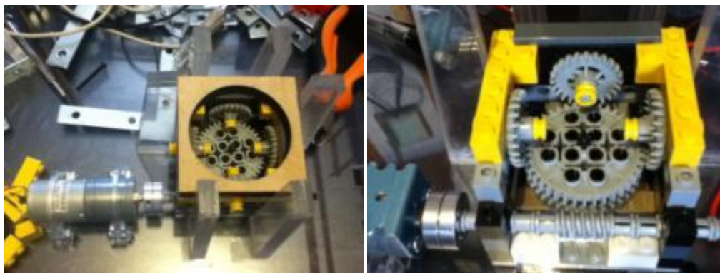
Figuras 3.20 y 3.21. Imagen del mecanismo de la base y motor acoplado a él (izquierda). Imagen del interior del mecanismo (derecha).
