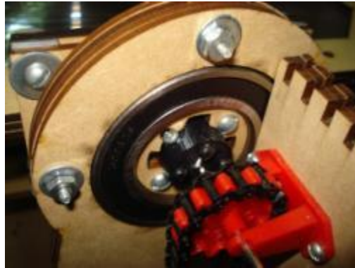
Figura 3.72. Imagen donde se observa la implementación del acople propuesto.
