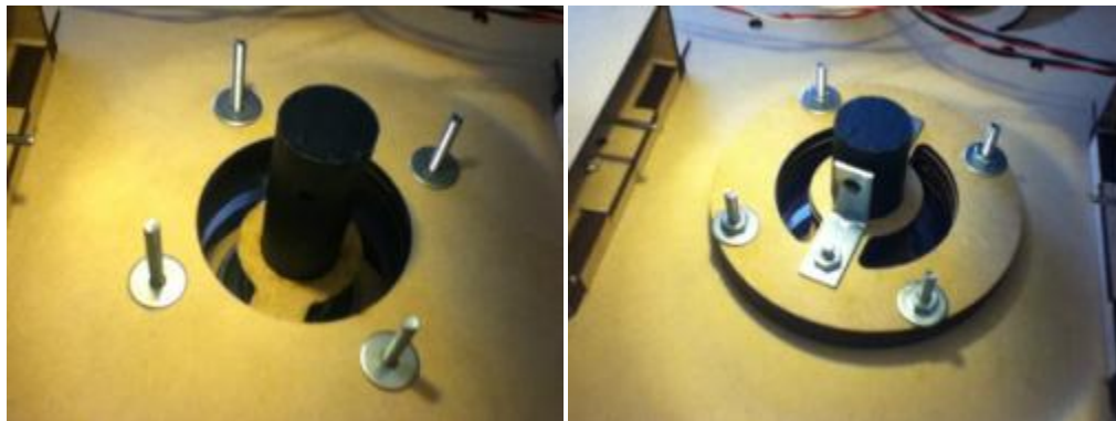
Figuras 3.39 y 3.40. Imagen de la plataforma colocada sobre el eje principal (izquierda). Imagen de la sujeción superior del eje principal debidamente atornillada a la plataforma (derecha).
