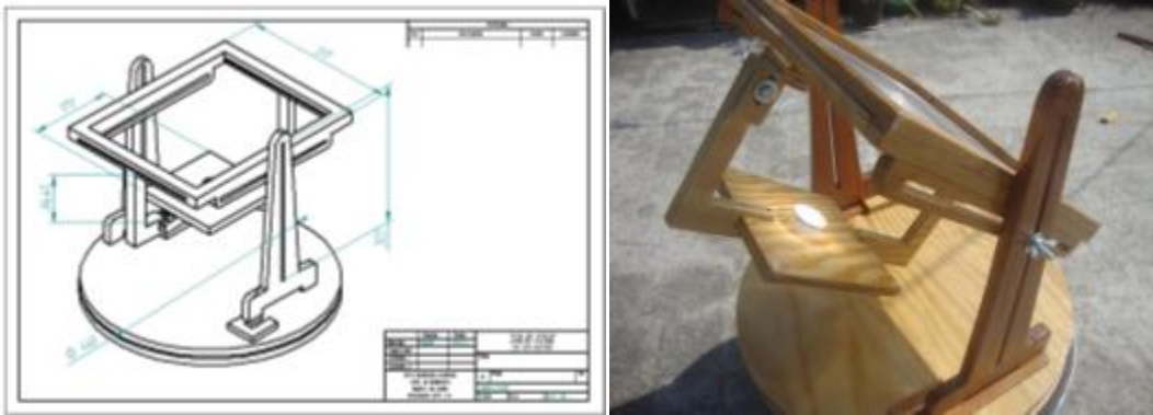
Figuras 1.2 y 1.3. Detalle de los planos del concentrador solar con lente de Fresnel (izquierda). Imagen del concentrador durante un experimento (derecha). [1.1]
