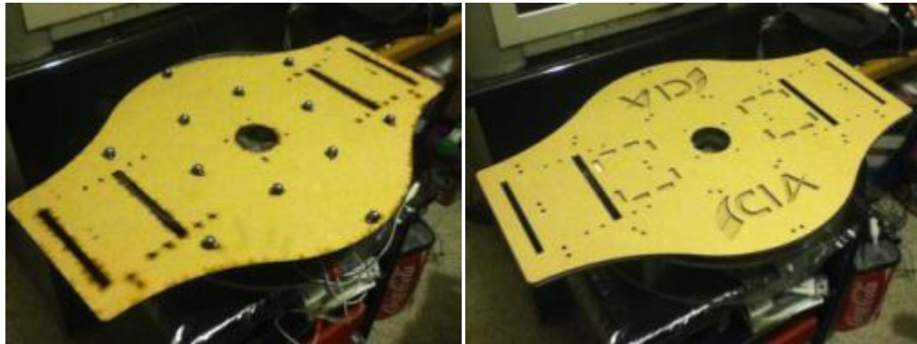
Figuras 3.29 y 3.30. Imagen de la vista inferior de la base móvil con todas las esferas colocadas (izquierda). Imagen de la plataforma totalmente ensamblada (derecha).
