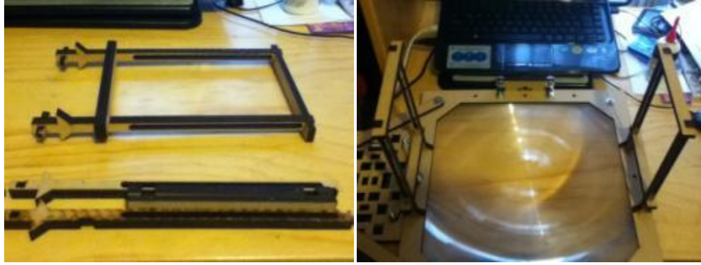
Figuras 3.82 y 3.83. Imagen de las piezas que conforman a la sección de los carriles (izquierda). Imagen de los carriles montados en el marco de la lente (derecha).
