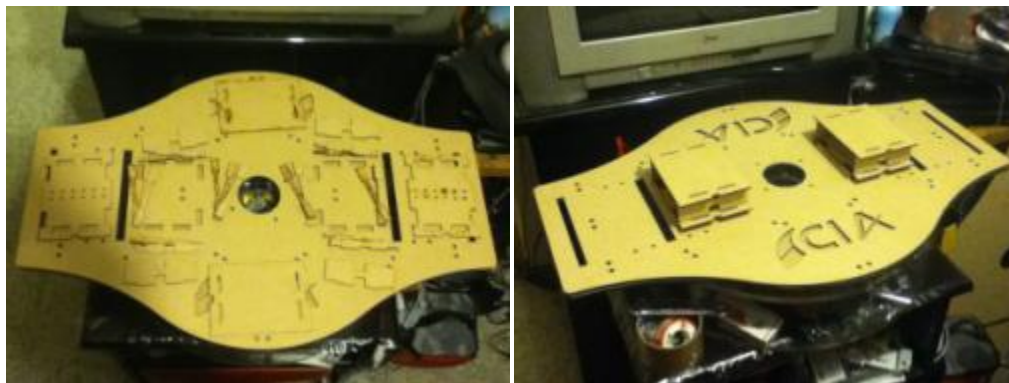
Figuras 3.43 y 3.44. Imagen de la base móvil con todas las piezas necesarias para las cajas de los motores (izquierda). Imagen del ensamble de las cajas (derecha).
