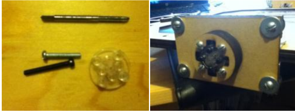
Figuras 3.68 y 3.69. Imagen del primer acople entre eje del mecanismo del poste y eje de la lente, junto con los tornillos usados para su instalación y machuelo (izquierda). Imagen de la instalación del primer acople y eje del marco de la lente (derecha).
