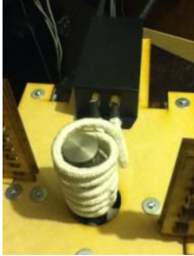
Figuras 3.113 y 3.114. Imagen del Matchbox colocado en la base del receptor con una probeta de estudio (izquierda). Imagen del sistema con receptor de sujeción y Matchbox completamente ensamblado (derecha).
