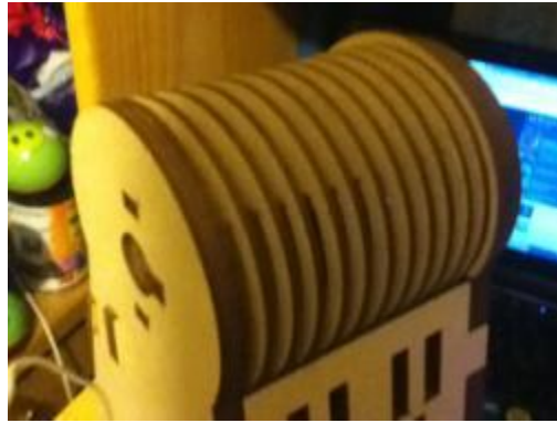
Figura 3.65. Imagen del grupo de piezas que recubren la punta del poste.
