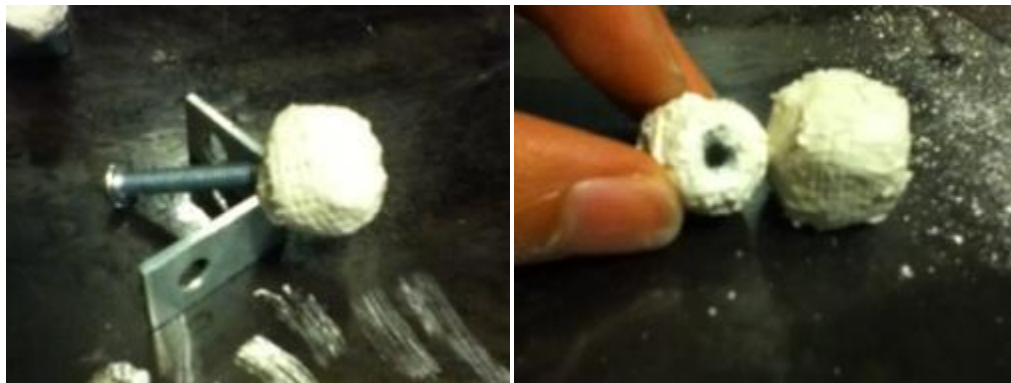
Figuras 3.105 y 3.106. Imagen del tornillo con punta de yeso (izquierda). Imagen de la punta de yeso removida del tornillo (derecha).
