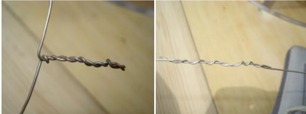
Figuras 4.12 y 4.13. Alambres de calibre 22 con amarres distintos. Son las “probetas” para la segunda etapa del experimento. Primera probeta (izquierda) y segunda (derecha).
