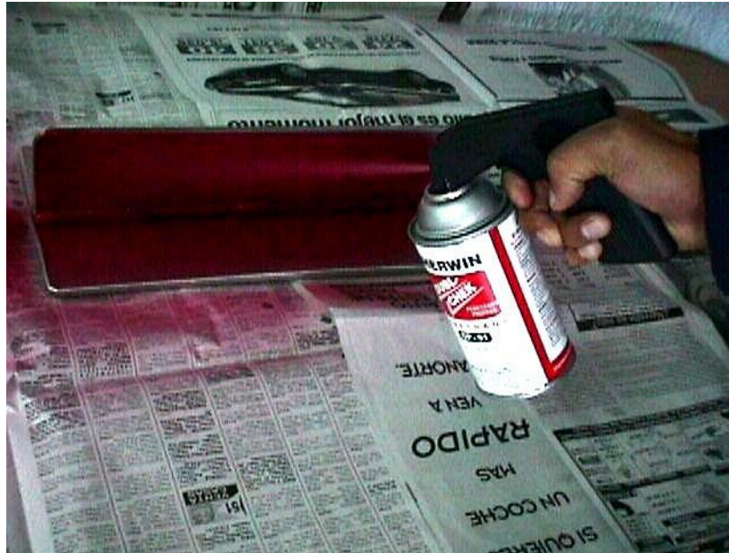
Figura 12. Aplicación mediante rocío en la técnica de líquidos penetrantes
