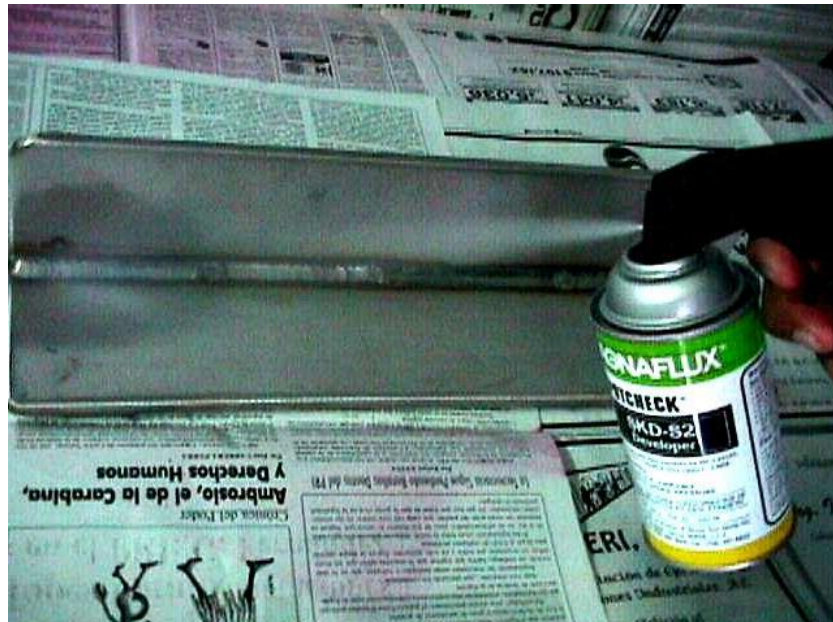
Figura 15. Aplicación del revelador en la técnica de líquidos penetrantes
