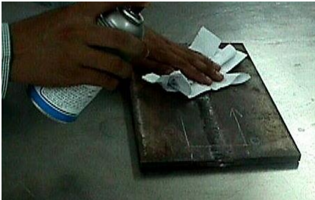
Figura 18. Limpieza final en la técnica de líquidos penetrantes
