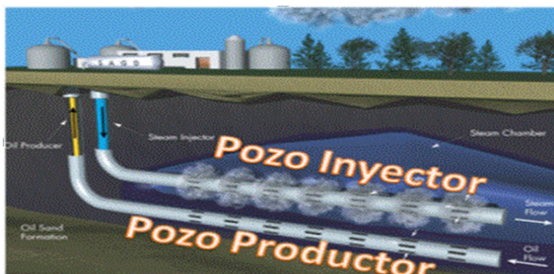
Figura3.2.1. Esquema de ubicación de pozos en SAGD.
