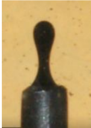
Figura 3.3: Gota de aceite en agua de formación + surfactante.
