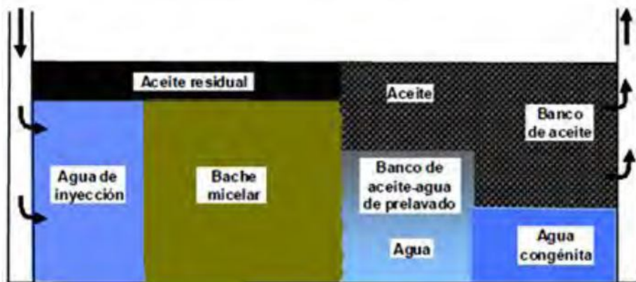
Figura 1.18: Procedimiento de inyección de soluciones micelares.
