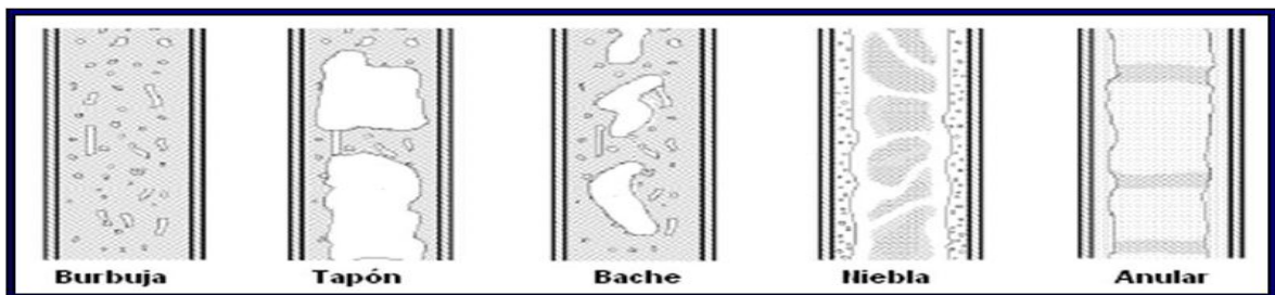
Fig. 2.1.1 Patrones de Flujo en tuberías verticales.
