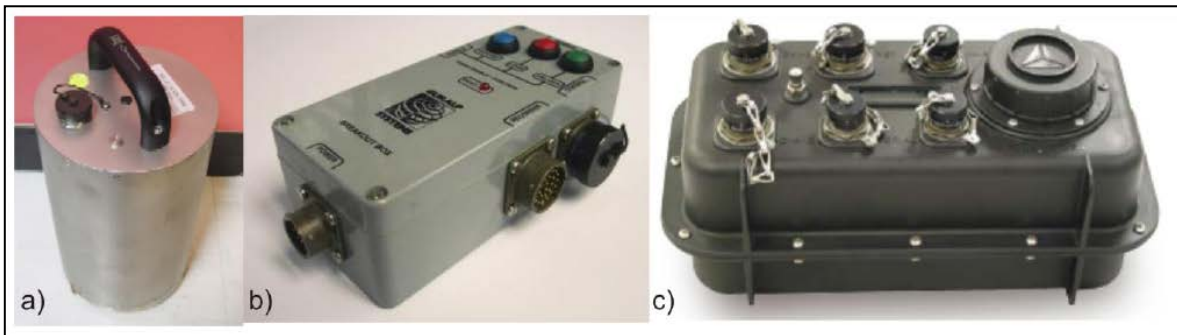
Figura 2.4. Equipo que operó en la estación TUXT. a) Sensor de banda ancha CMG-3T. b) Unidad de control del sensor. c) Digitalizador Reftek 130-01. Tomada de Melgar Moctezuma (2009).
